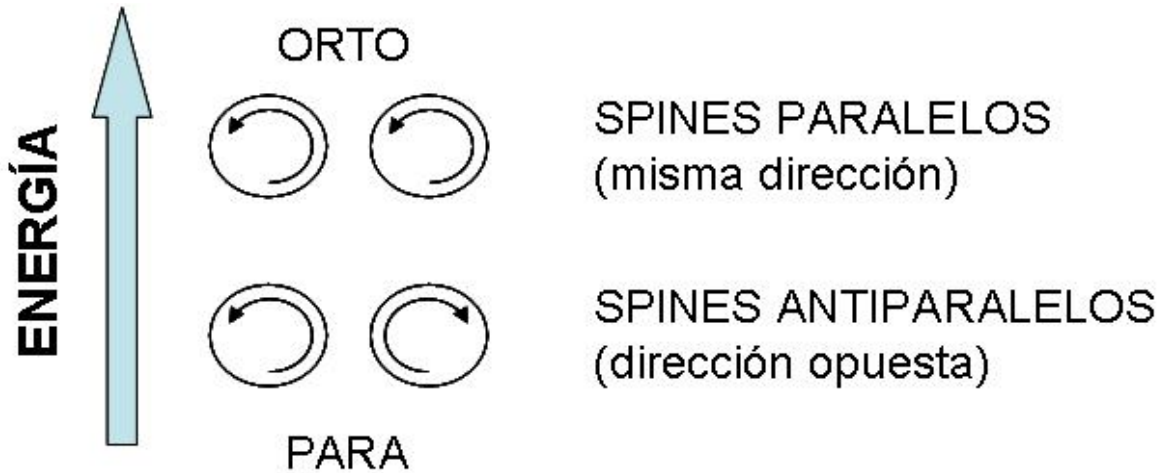
Figura 56: Sentido de giro de electrones y nivel de energía en orto-hidrógeno y para-hidrógeno
