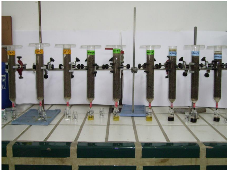
Figura II.11. Columnas de vidrio empaquetadas a mano con los suelos usados.
