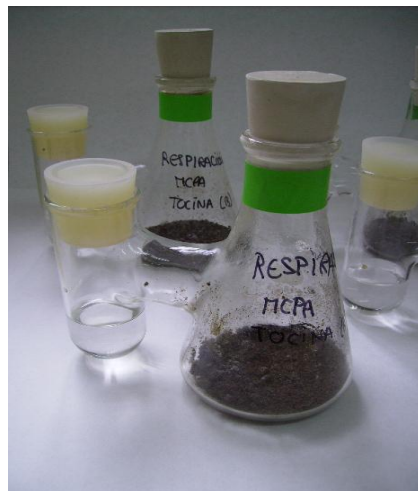
Figura II.7 . Matraces biométricos usados en los estudios de respiración basal de los suelosII.3.4.-
