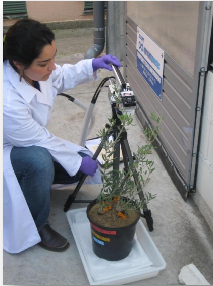
Figura IV.5. Analizador de gases por infrarrojo (IRGA) usado para las mediciones durante el experimento.
