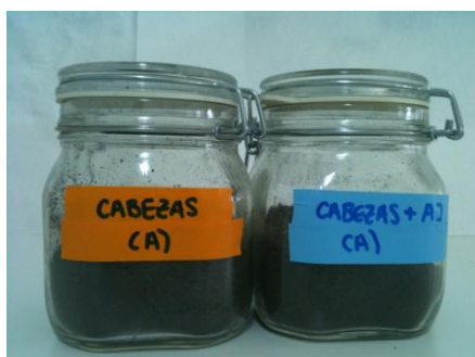
Figura II.10. Tarros herméticos para estudio de disipación de los herbicidas.
