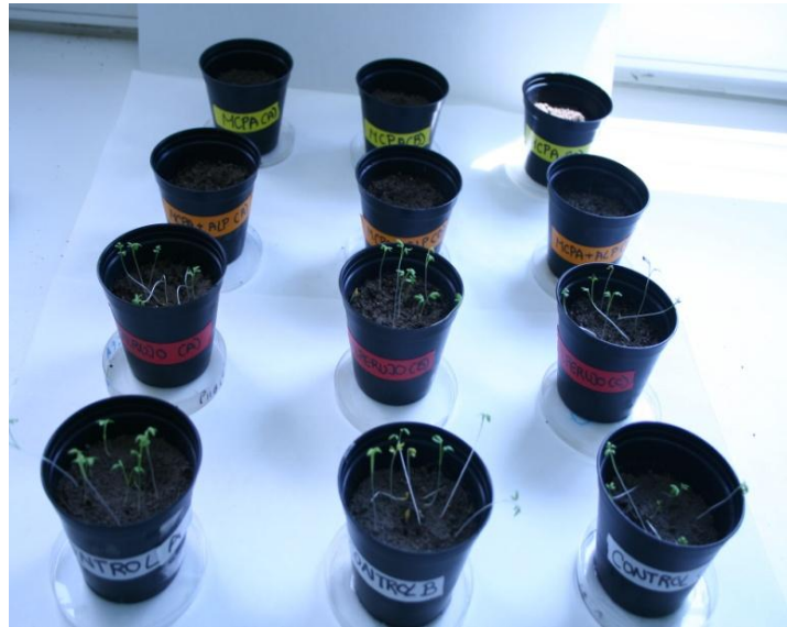
Figura II.22. Resultados del bioensayo con Lepidum sativum L. Efecto de la adición de alperujo sobre la fitotoxicidad de MCPA.
