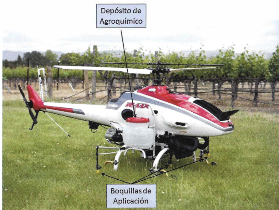
Foto 1. Aplicación localizada de agroquímicos con helicóptero no tripulado.
