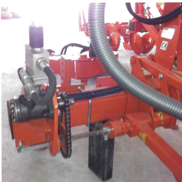
Foto 4 (izda.). Válvula de control de flujo y motor hidráulico de velocidad variable. Foto 5 (dcha.). Actuador eléctrico en abonadora variable para sólidos.
