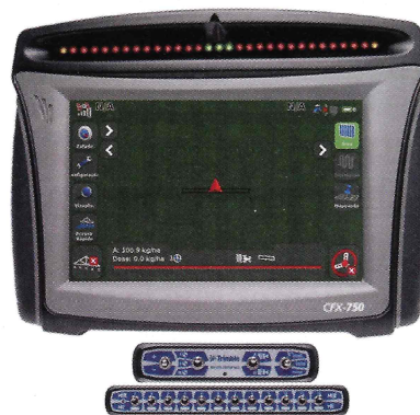
Foto 3. Display con receptor GPS integrado junto al controlador de aplicación variable que permite una mejor eficiencia en el uso de fertilizante (Fuente: Trimble).
