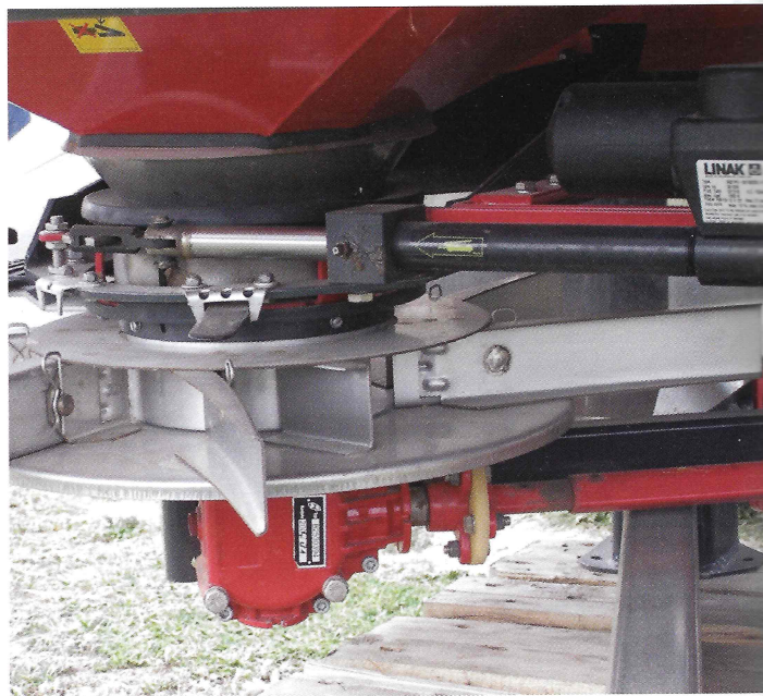
Foto 4 (izda.). Válvula de control de flujo y motor hidráulico de velocidad variable. Foto 5 (dcha.). Actuador eléctrico en abonadora variable para sólidos.
