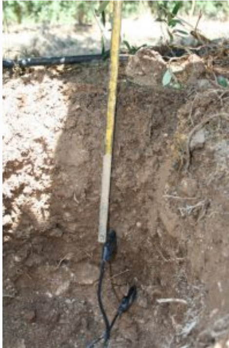
Foto 1b. Sensores colocados en el suelo para medir la temperatura, la humedad y la conductividad eléctrica.
