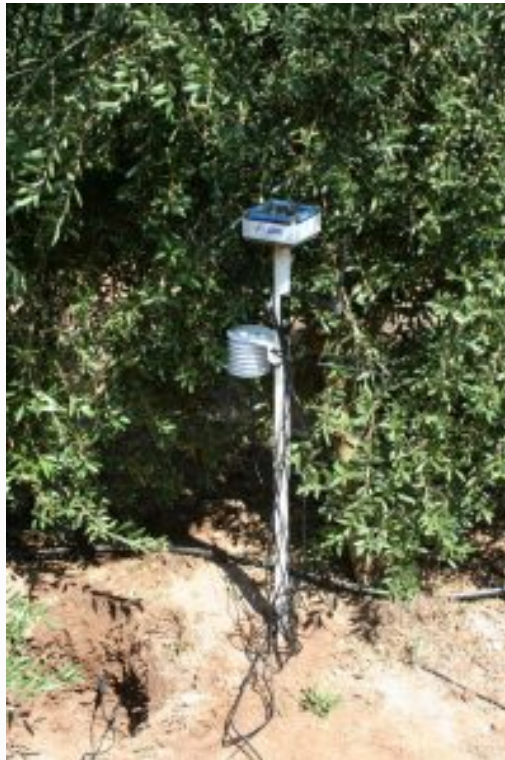
Foto 1a. Nodo instalado en un olivar superintensivo usado para la programación de riegos de precisión.
