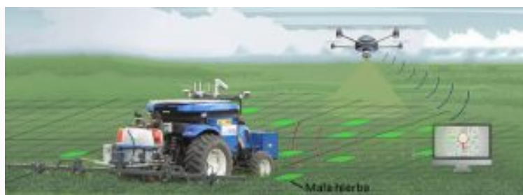
Figura 2. Ilustración de un pulverizador inteligente aplicando de forma localizada en los lugares donde el dron detectó mala hierba en campo.
