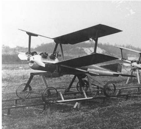
Figura 1-2. Kettering Aerial Torpedo “Bug”, uno de los primeros sistemas aéreos no tripulados (1917)
