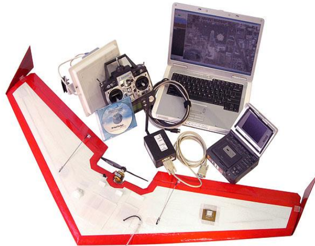
Figura 2-7. “Unicorn”, UAV de ala fija utilizado en Utah
