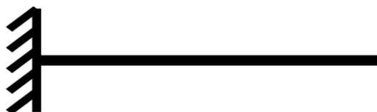
Figura 3-27. Viga en voladizo
