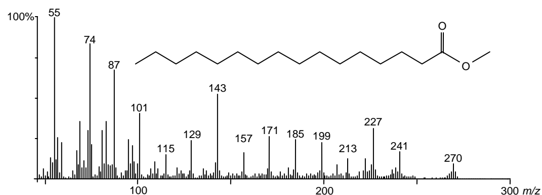
Figura 16. Espectro de masas del ácido hexadecanoico metilado.
