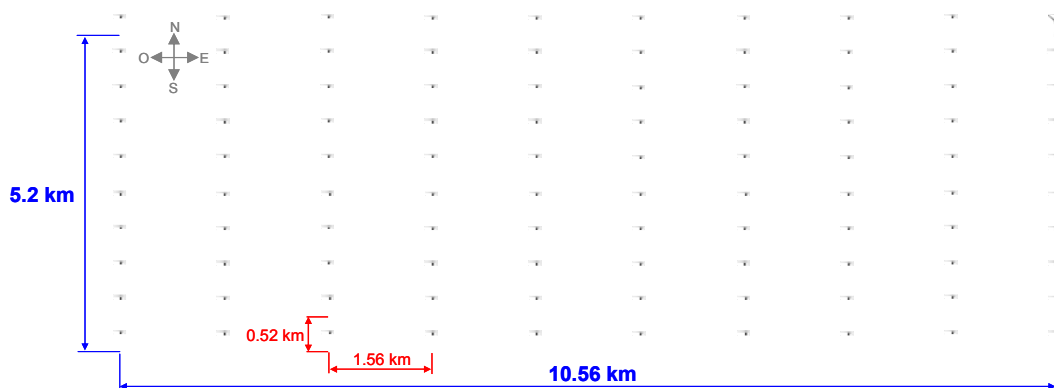
Figura 140. Disposición geográfica de los aerogeneradores en el parque eólico analizado en el Caso 6.1
