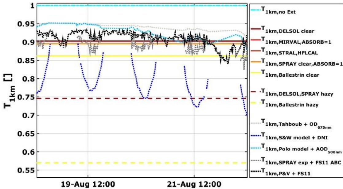
Figura 4.4. Transmitancia para un slant range de 1 km obtenida con distintos modelos descritos en la Sec. 4.1. para un período de tiempo entre el 18 y 22 de agosto de 2013 en PSA. [22]
