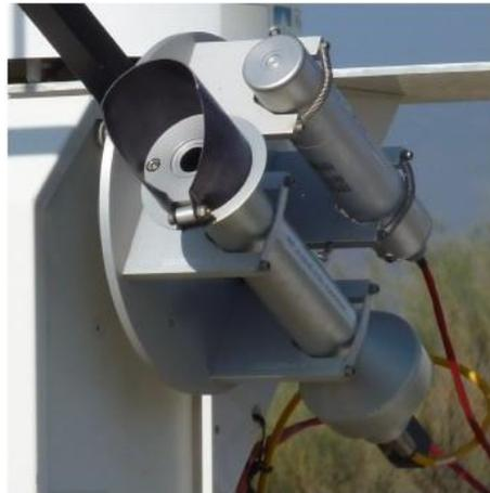
*Figura 5.5. CHP1 de Kipp & Zonen sobre un seguidor solar en PSA.*
