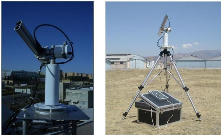
*Figura 5.3. Fotómetro CIMEL C318. A la izquierda, con plataforma fija a la derecha, con plataforma temporal.*
