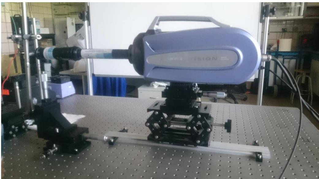
Figura 2-19. Cámara de alta velocidad HPV-2
