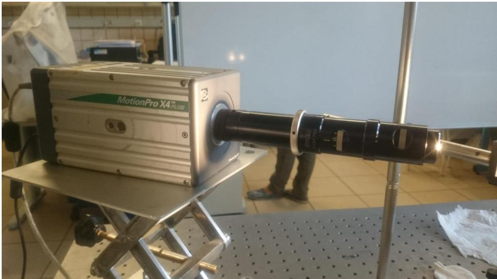
*Figura 2-20. Cámara MotionProX4 Plus*
