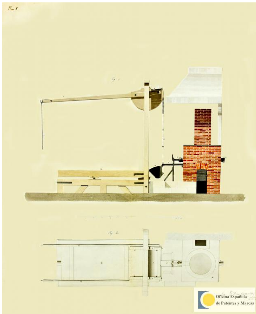
4. “Aparato para fundir planchas delgadas de plomo que no tienen necesidad de pasar por los cilindros”, introducido por Juan de Dios Govantes. 1828.
