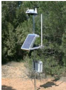
Figura 5: Nodo sensor de la red ICARO
