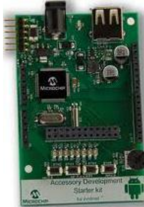
Figura 2-9. Placa de desarrollo Microchip PIC24F. Fuente: [14]
