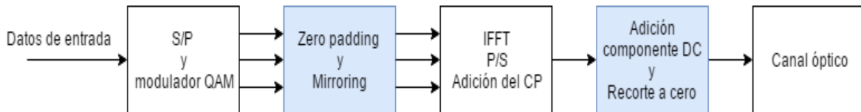
Figura 3-1. Esquema del transmisor DCO-OFDM. Los bloques que no pertenecen al transmisor OFDM original se han rellenado de color azul.
