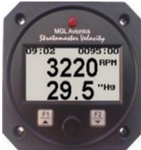
Ilustración 5.3: Sensor de presión y velocidad de giro ( aircraftspruce.com )
