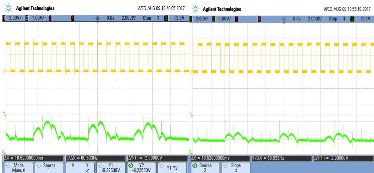
Figura 3-5. Rizado de alimentación Vcc antes(izquierda) y después(derecha)
