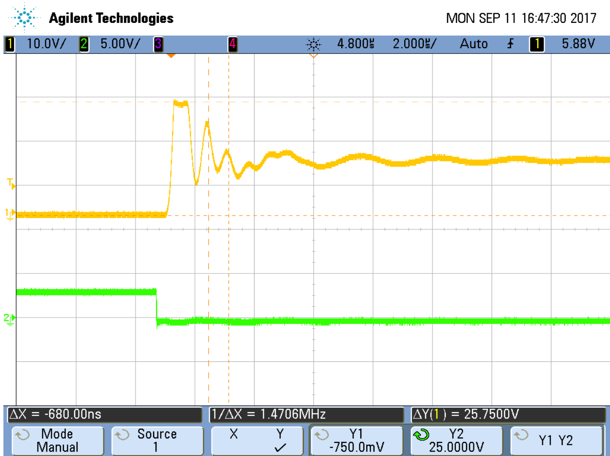
Figura 4-8. Sobreoscilación en el disparo del Mosfet
