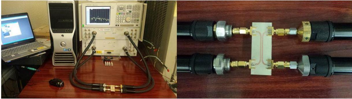
Figura 3.2: Montaje para la medida de las líneas con el analizador de red.
