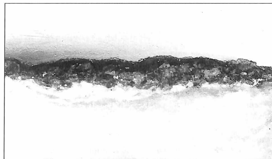
Figura 2. Fotomicrografía de la sección transversal de una muestra de pintura sobre tabla. Magnificación 200x (ver cuadernillo a color, pág. i).
