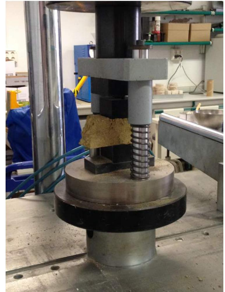
(Fig.4.52) Disposición de probeta sometida a compresión
