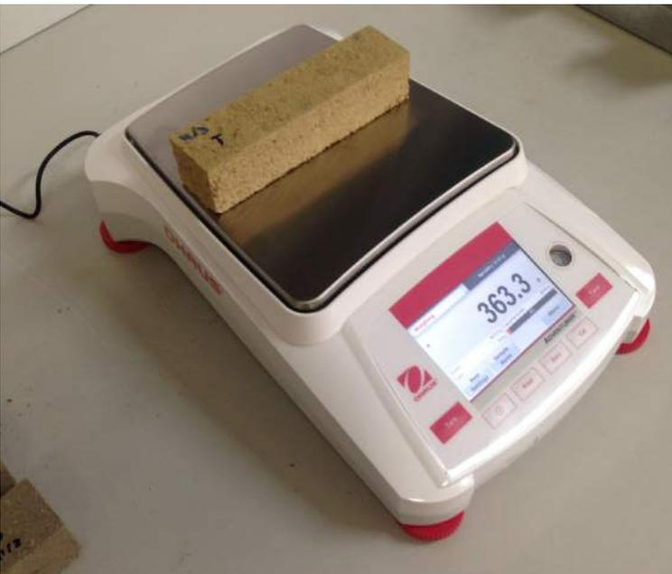
(Fig.4.19) Pesado de probetas prismáticas en la báscula
