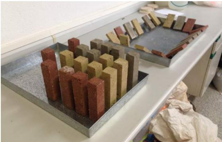
(Fig.4.33) Separación de probetas que permitan su secado
