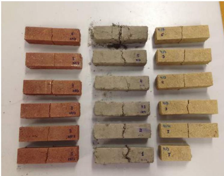
(Fig.4.43) Resultado tras la rotura de las probetas
