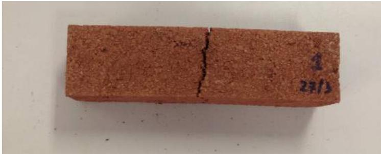
(Fig.4.42) Probeta de suelo rojo rota a flexión
