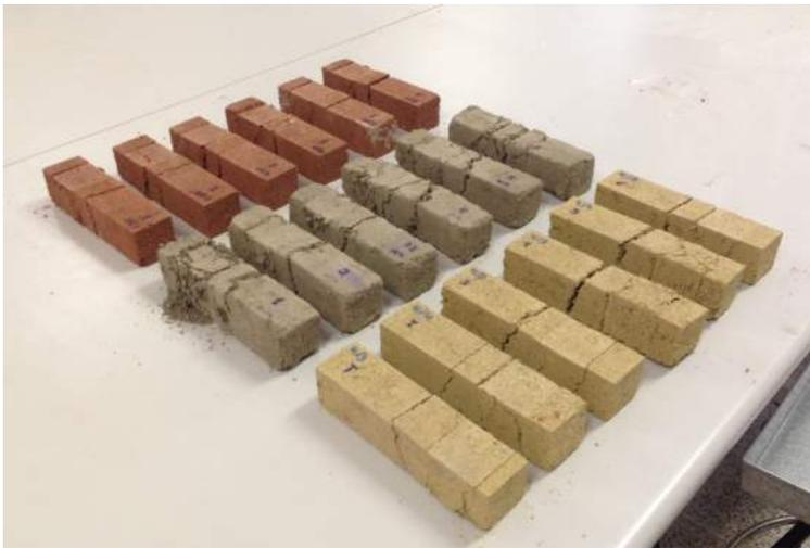
(Fig.4.61) Probetas ensayadas a compresión y flexión
