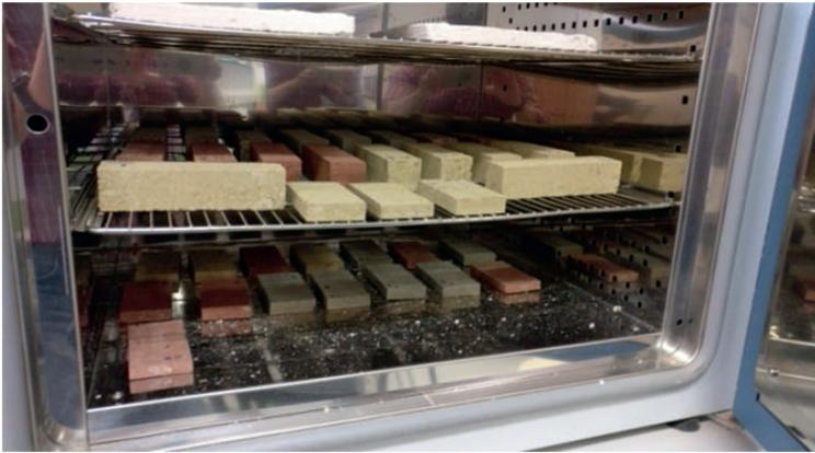
(Fig.4.28) Secado en estufa hasta peso constante
