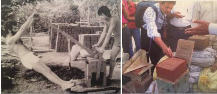
(Fig.1.44) Proceso de compactación de un BTCE
