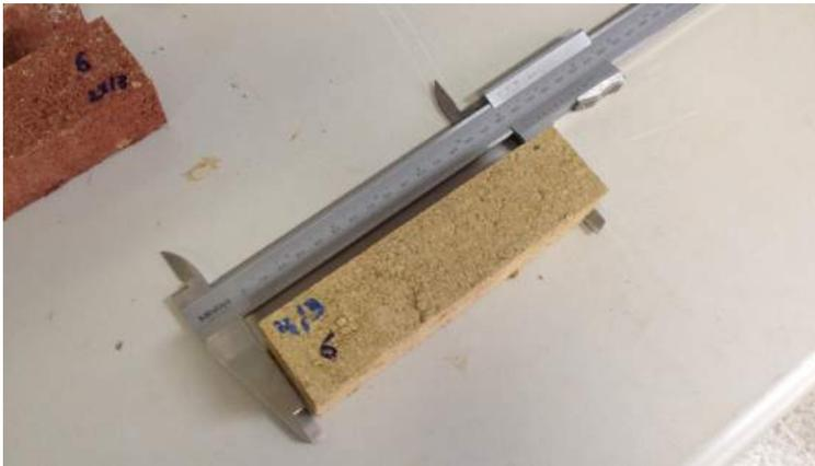
(Fig.4.18) Medición de las probetas prismáticas con pie de rey
