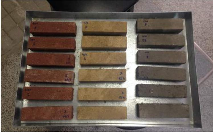
(Fig.4.32) Preparación para introducir las en el congelador
