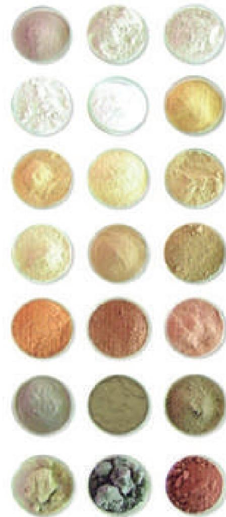
(Fig.1.6) -Ejemplos de arcillas de diferentes composiciones mineralógicas
