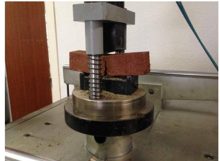
(Fig.4.41) Rotura de la probeta a flexión
