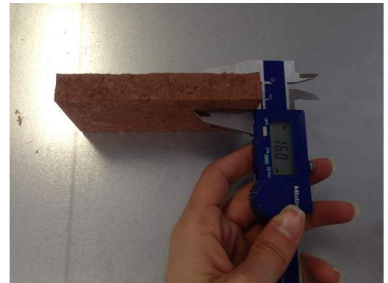
(Fig.4.20) Medicion de las probetas tipo baldosas con pie de rey
