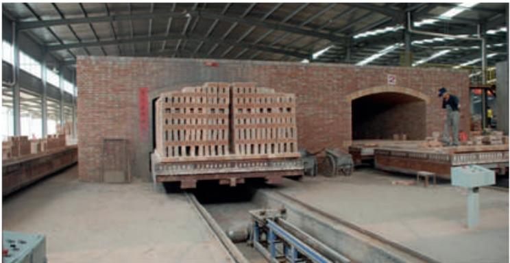
(Fig.0.7) Túnel de secado y cocción de ladrillos convencionales
