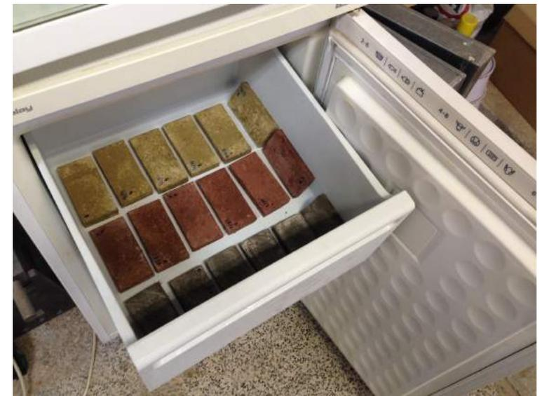
(Fig.4.31) Congelación de las probetas humedecidas
