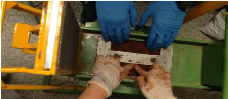
(Fig.4.10) Presión manual por tongadas ensayar
