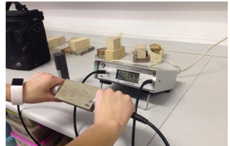
(Fig.4.23) Medición a ultrasonidos a probetas de baldosas
