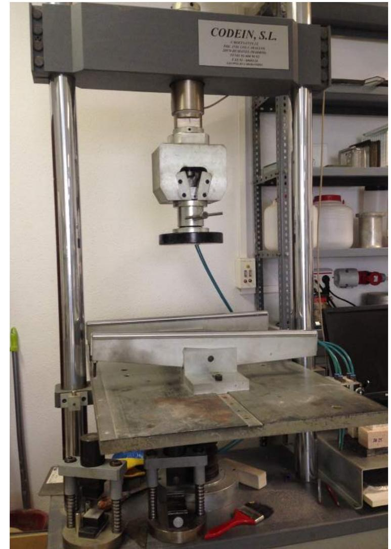
(Fig.0.12) Prensa multiensayo para realizar los ensayos de compresión y flexión
