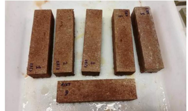
(Fig.4.30) Absorción de las probetas del agua superficial
