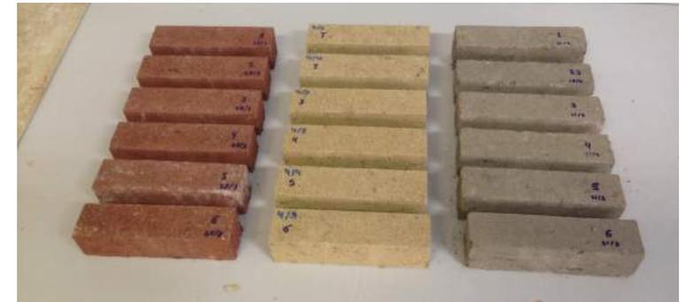
(Fig.4.16) Probetas tipo prismáticas a ensayar
