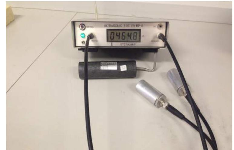
(Fig.4.22) Modelo ultrasónico con transductores cilíndricos y piezas de tarado
