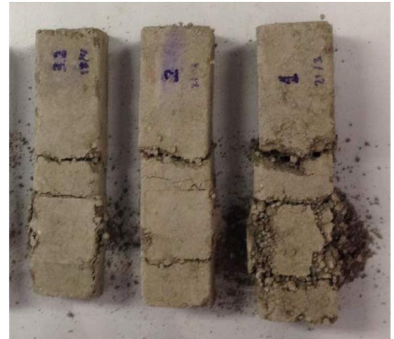
(Fig.4.57) Probetas de arcilla negra rotas a compresión y flexión
