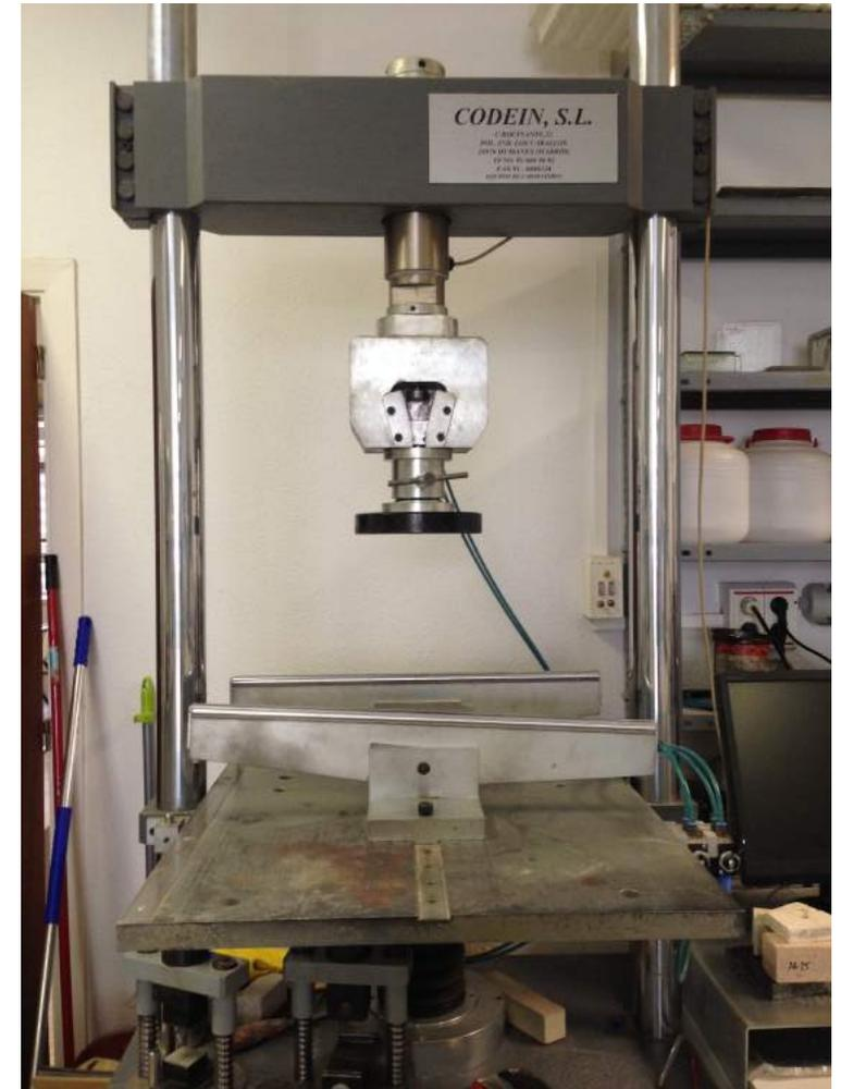
(Fig.4.37) Prensa multiensayo para realizar los ensayos de compresión y flexión
