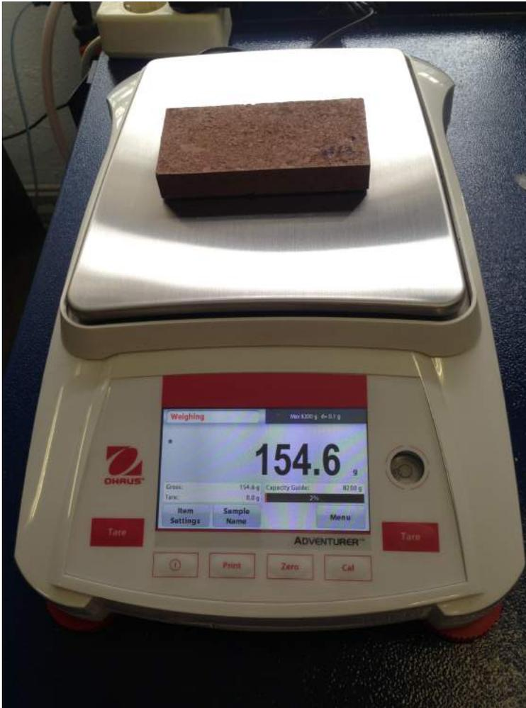
(Fig.4.21) Pesado de probetas tipo baldosas en la báscula
