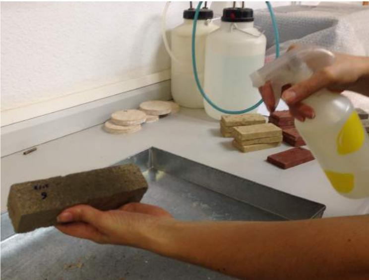
(Fig.4.29) Humectación de las caras de las probetas
