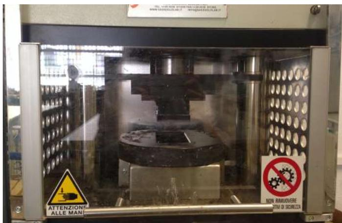
(Fig.3.15) Prensa mecánica para elbarorar dos probetas prismáticas
