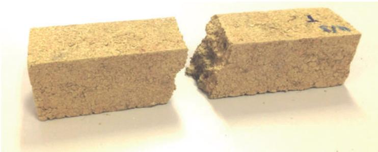
(Fig.4.50) Probeta rota a flexión. Elección de una parte a ensayar a compresión.
