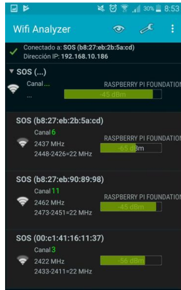
Figura 43. Variaciones en la potencia de la señal de red SOS
