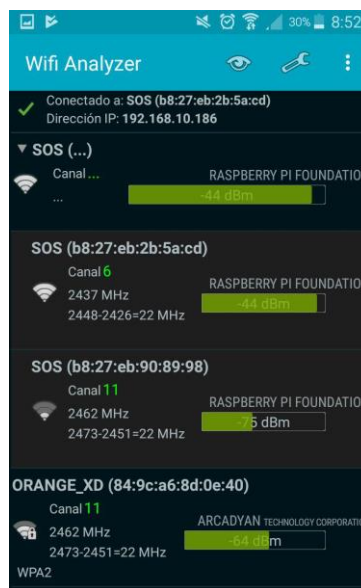
Figura 42. Nivel de potencia recibida de la señal de red SOS
