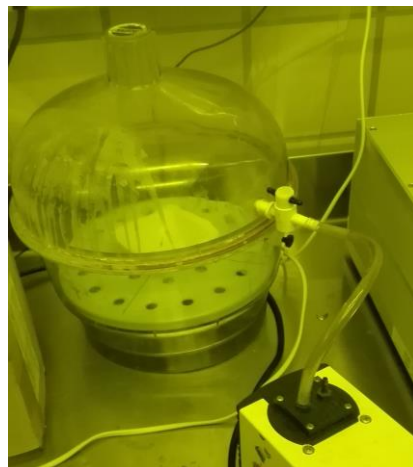
Figura 4-23. Cámara de vacío
