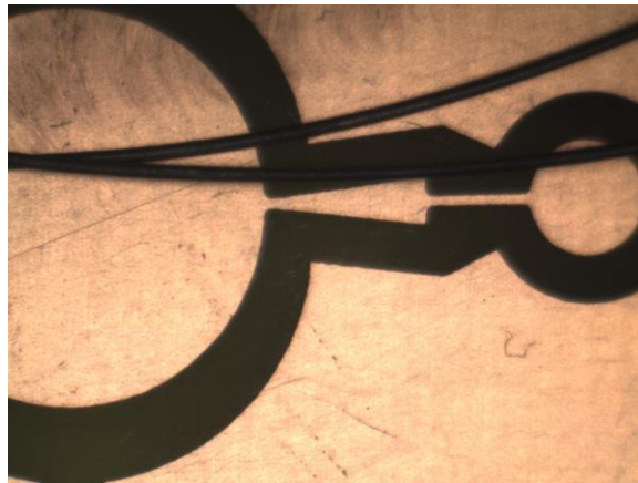
Figura 4-17. Detalle molde de PCB con cable de 360 μm de diámetro
