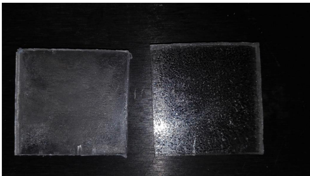
Figura 3-5. Metacrilato antes de ser expuesto a vapor de IPA (izquierda) y después (derecha).
