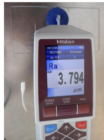
Fig. 18. Medición en el rugosímetro antes del blanqueamiento dental
