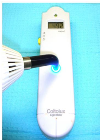
Fig. 27. Lámpara de fotopolimerizado Degulux (Degusa) y Radiómetro Cultolux (Coltene Waladent)
