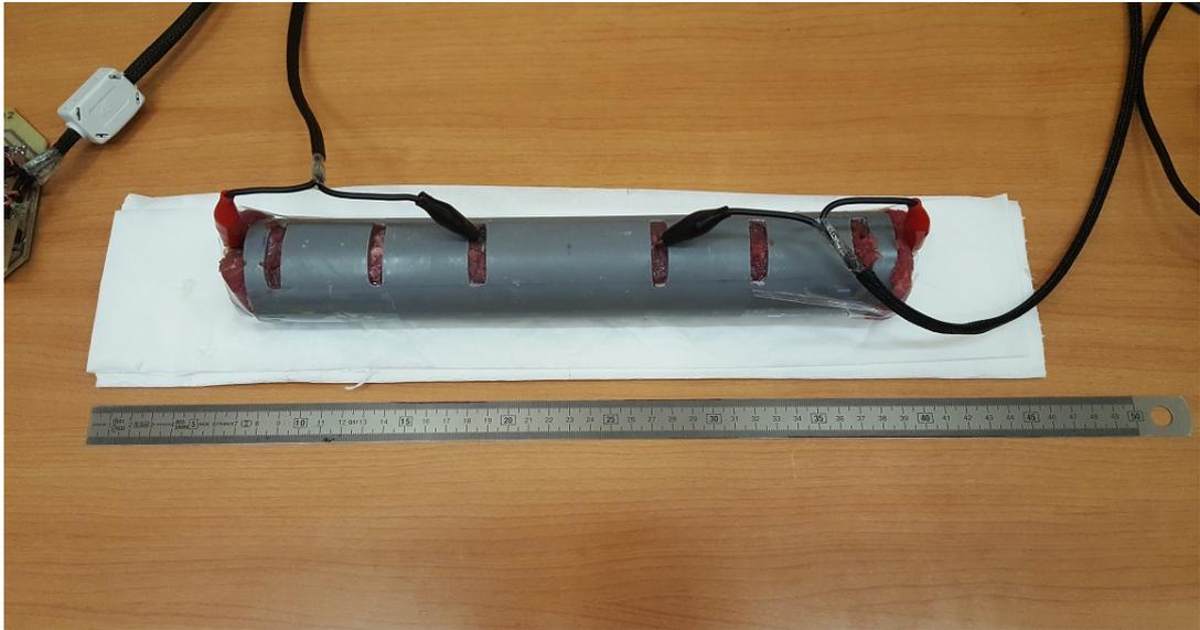
**Figura 4.7** Distribución de los electrodos en la muestra para una distancia de separación de 8.5cm.
