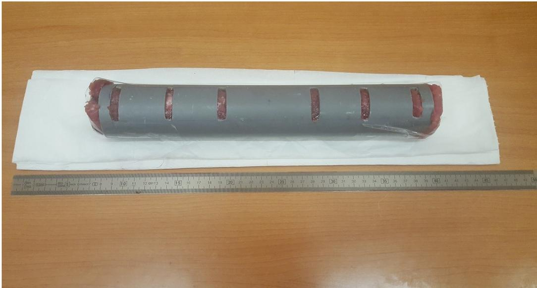
**Figura 4.4** Tubo de PVC con las incisiones para la medición y con el tejido muscular en su interior.
