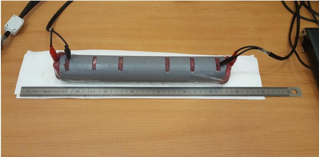
**Figura 4.5** Distribución de los electrodos en la muestra para una distancia de separación de 26.5cm.
