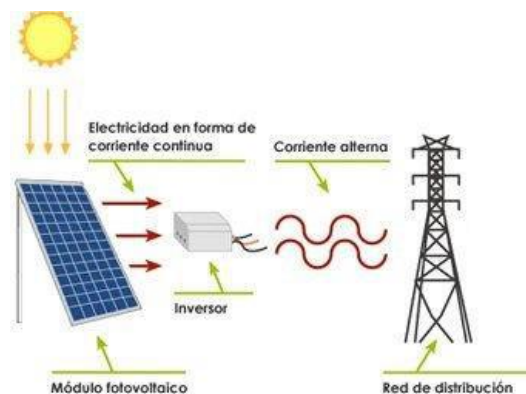
Figura 4-7. Esquema general de la instalación fotovoltaica.
