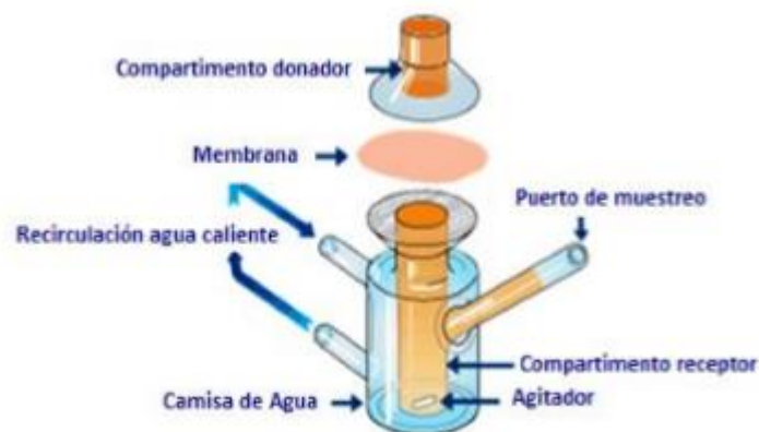
Figura 9. Esquema de una celda de Franz utilizada para los ensayos de permeación.
