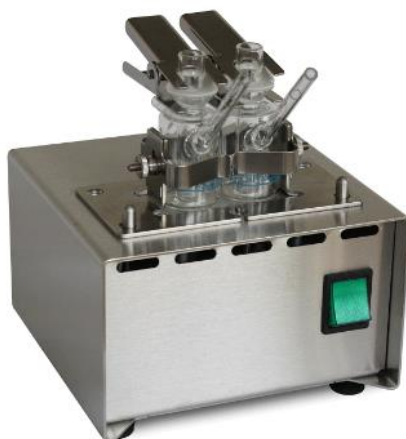
Figura 10. Equipo termostatzado para un estudio de permeación.
