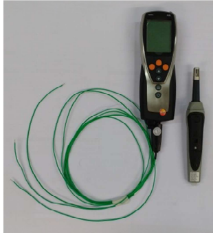
Imagen 28: Equipo TESTO 435-2. Gestor de datos y sondas de temperatura. Fuente: Elaboración propia.
