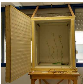
Imagen 27: Caja térmica instalada en el laboratorio. Al fondo, cara interior del cerramiento que la separa del ambiente exterior, con varias sondas de temperatura instaladas. Fuente: Elaboración propia.
