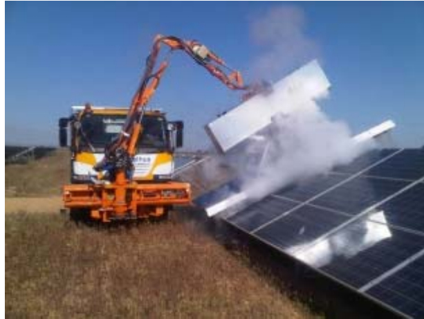
Figura 17. Limpieza con vapor de agua. Fuente: ECOTicias.com
