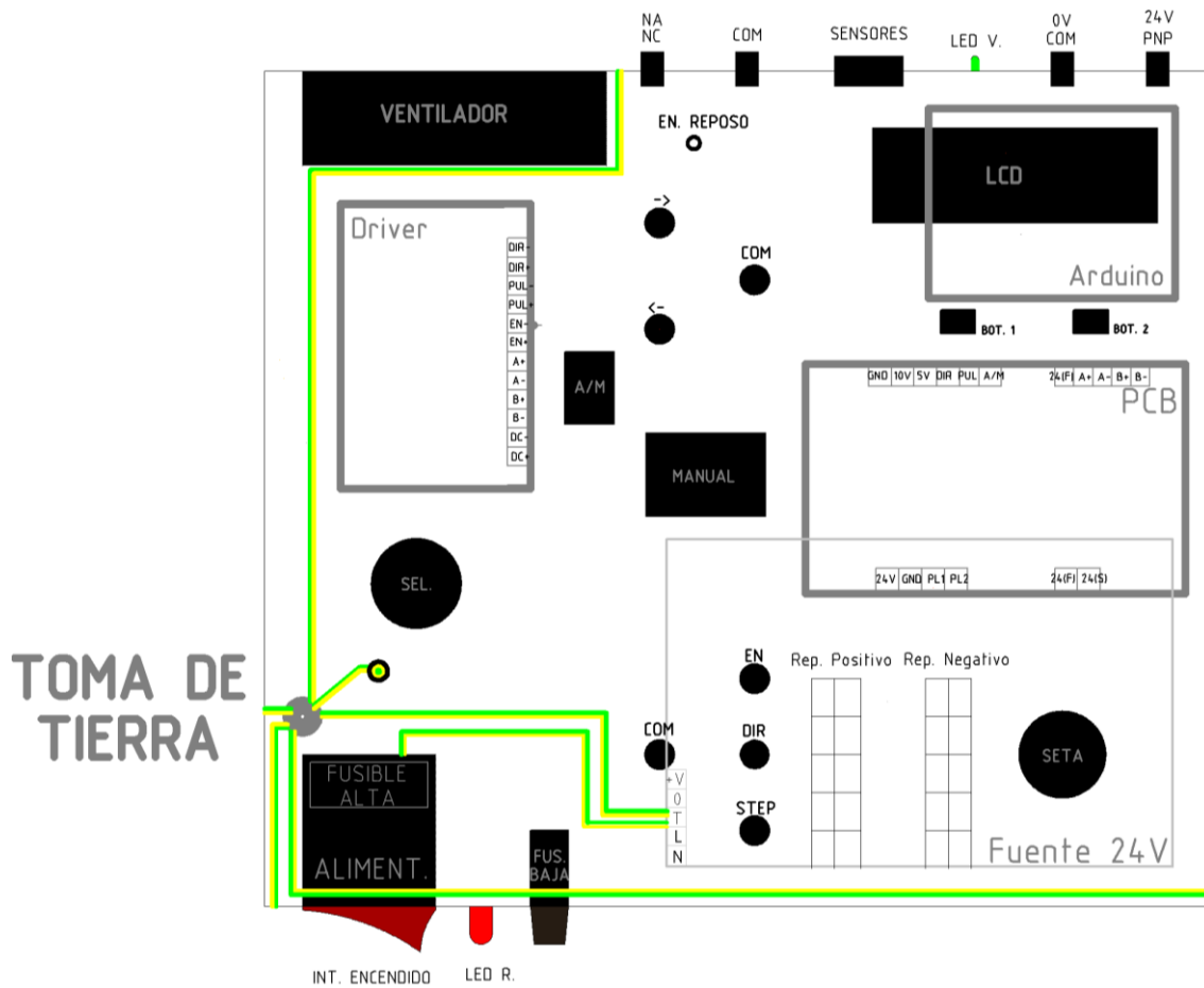
Figura 49. Cables de tomas de Tierra
