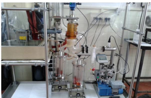
Figura II.2.- Dispositivo Short-Path (mod. KDL5) perteneciente al Instituto de la Grasa. CSIC
