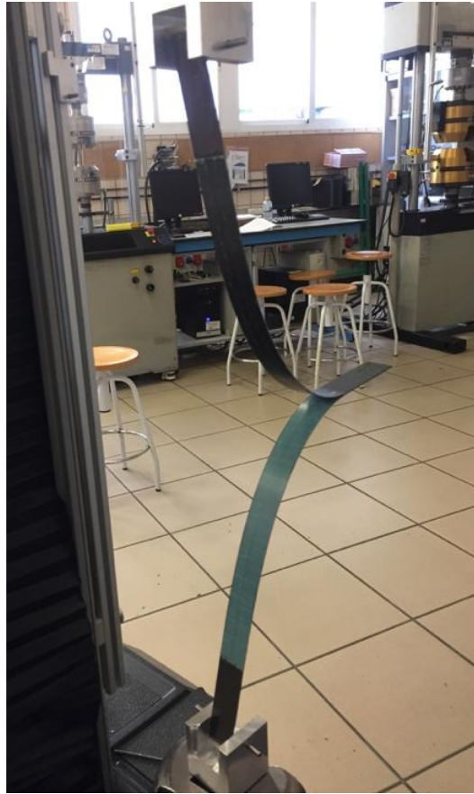
Figura 46: Grandes desplazamientos en el ensayo DCB.
