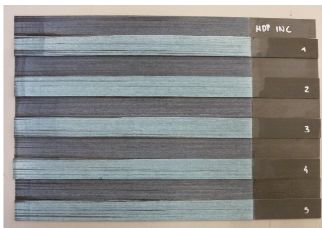
Figura 59: Modos de fallo en HDP para probetas incompatibles.
