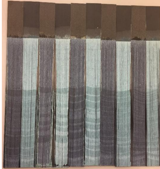
Figura 45: Mecanismos de fallo de las probetas simétricas [8+8] para G_{IC} .
