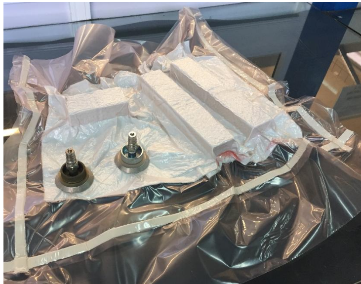
Figura 30: Bolsa de vacío para probetas del ensayo a tracción.
