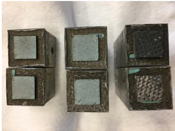
Figura 41: Modos de fallo del espécimen 1,3 y 2 de izquierda a derecha.
