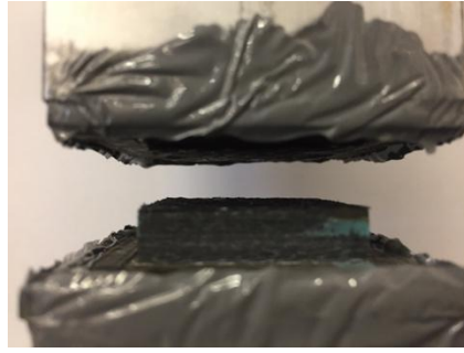
Figura 39: Delaminación del espécimen 2.
