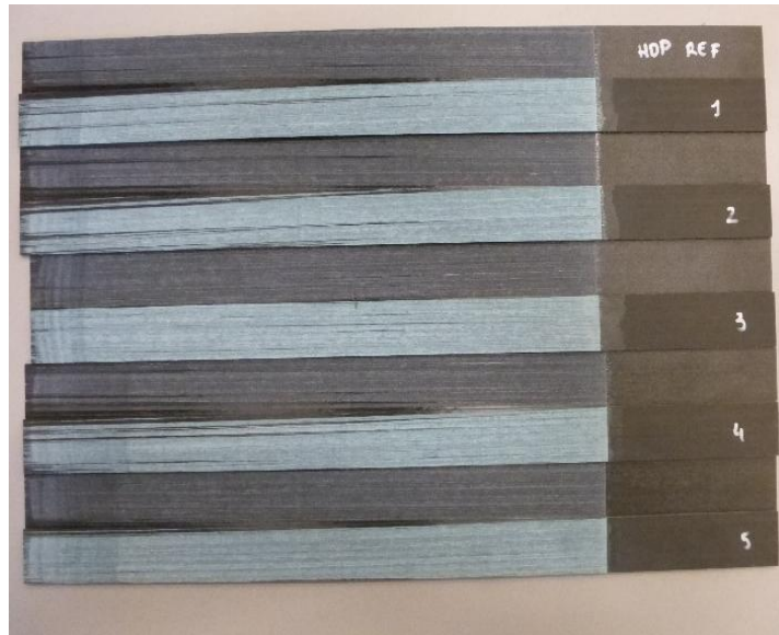
Figura 55: Modos de fallo para el HDP para probetas compatibles.
