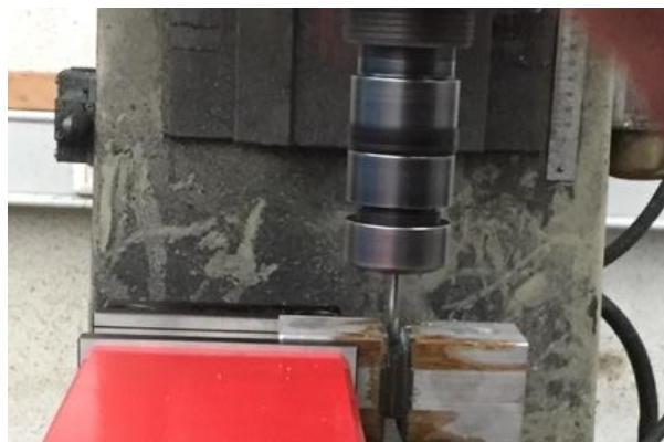
Figura 31: Eliminación del rebose del adhesivo.
