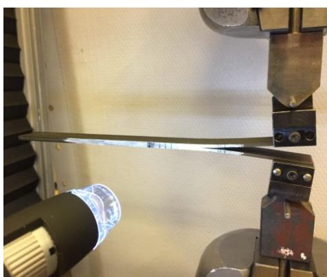
Figura 44: DCB con cámara ampliadora.
