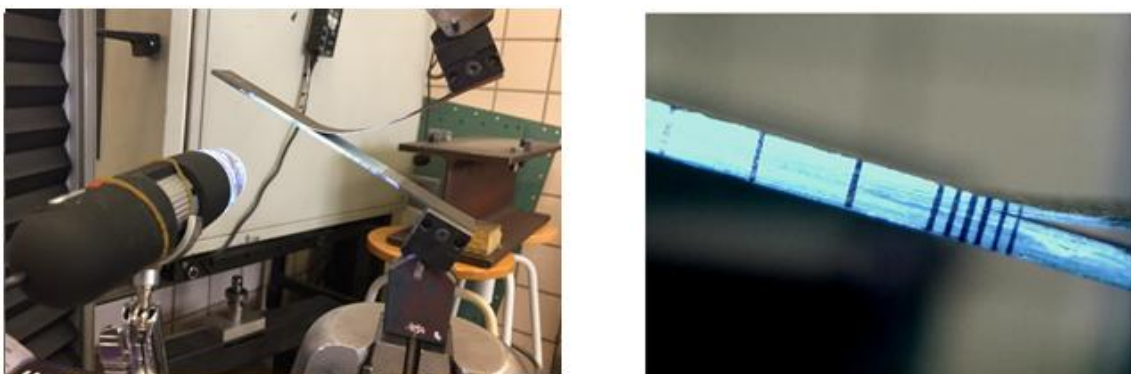
Figura 49: Desarrollo del ensayo DCB.
