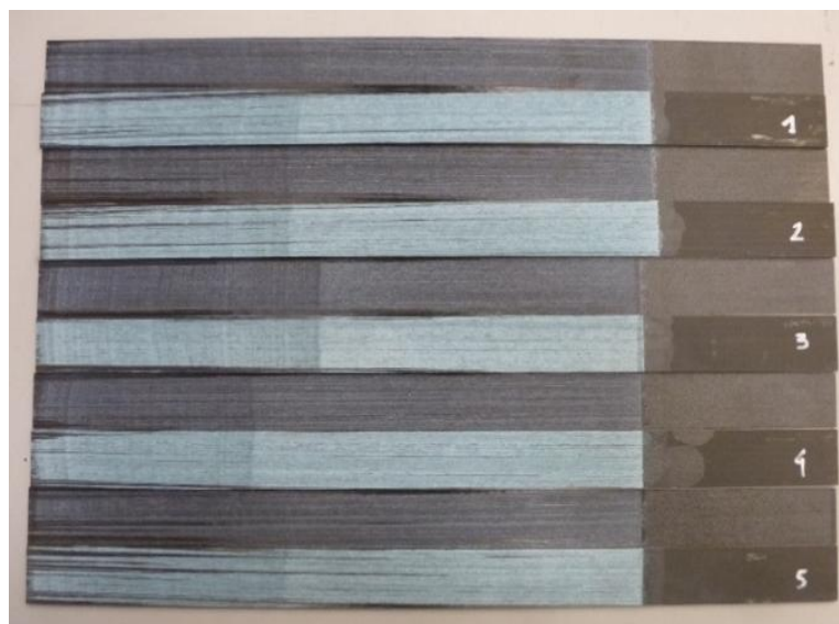
Figura 52: Modos de fallo al realizar CDP en probetas compatibles.
