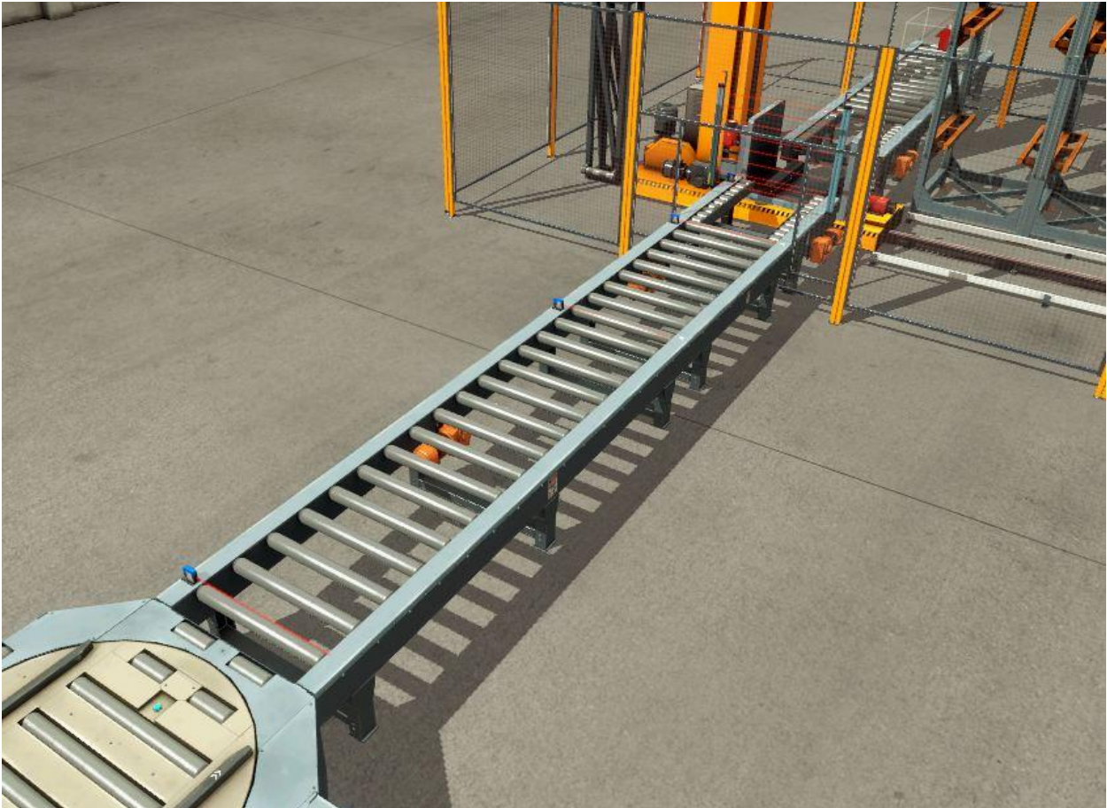
Figura 25. Cintas de entrada al almacén automatizado.
