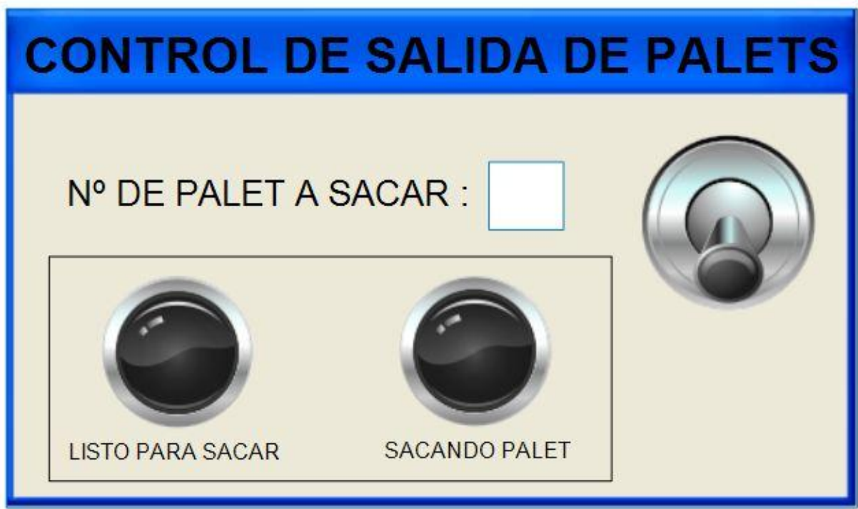
Figura 32. Pantalla SCADA para sacar palets del almacén automatizado.
