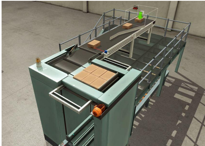
Figura 18. Colocación 1 de las cajas de la paletizadora almacén automatizado.
