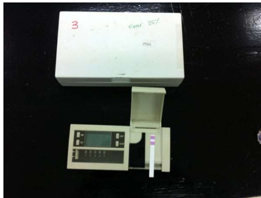
Ilustración 31. Reflectómetro utilizado para medir nitratos.
