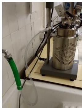
Fig.15.Refrigeración externa para el circuito que refrigera el motor rotatorio del mini reactor.
