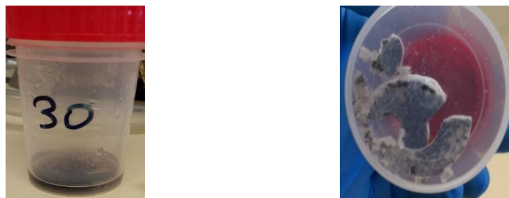
Fig.32. A la izquierda gel húmedo en forma de disco ( \phi \approx 30 \text{ mm} y h \approx 3 \text{ mm} ). A la derecha, muestra después del secado supercrítico
