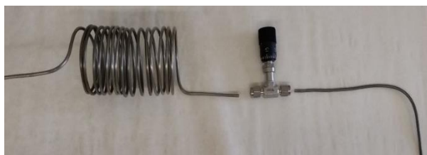
Fig.21. Serpentín metálico (izquierda) de 16 vueltas, creado específicamente para este experimento y válvula de precisión (derecha).
