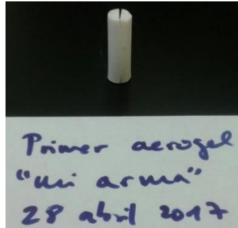
Fig.30. Primer aerogel obtenido a través del secado supercrítico en el depto. de Física de la Materia Condensada de la Universidad de Sevilla
