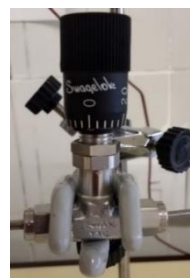
Fig.22. Válvula de precisión, observación de su sensibilidad con respecto
