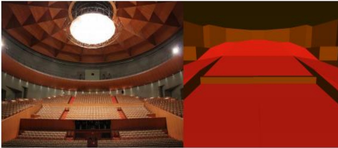
Figura 5.6-1: 3 D- modelización para la simulación acústica de recintos escénicos de gran capacidad.
