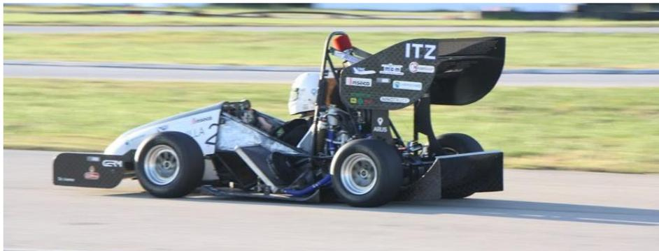
Ilustración 10.- En la foto se observa el ART-16 durante un test. Se observa que la admisión tiene una posición muy perjudicial para el flujo que llega al alerón trasero.
