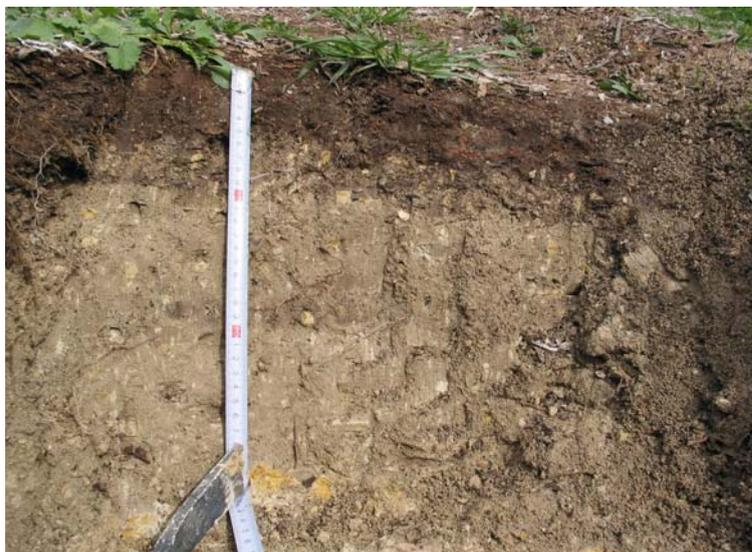
Figura 4.32. Fotografía del perfil del suelo del olivar experimental de Mengíbar (Jaén) donde pueden apreciarse grietas, responsables del fenómeno de flujo preferencial.
