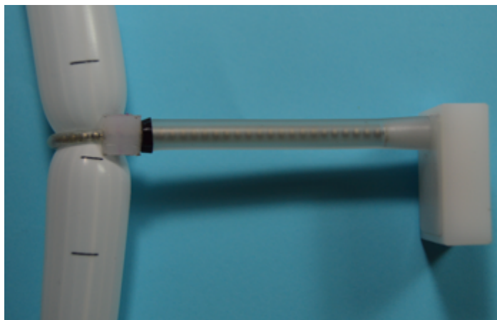
Imagen 31: Dispositivo banding fijado a un modelo de arteria pulmonar, nótese que no existe tracción sobre el modelo.
