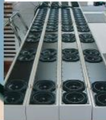
Producción eficaz en las cubiertas de los altavoces. Pegado de los paneles flexibles dentro de capas múltiples, eliminando fijaciones mecánicas, y ofreciendo un mejor acabado.
