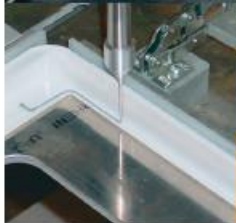
Aplicación con robot de un sistema de adhesivos aplicando Sikadur® que permite los ciclos cortos de producción equivalentes en la fabricación de moldes.
