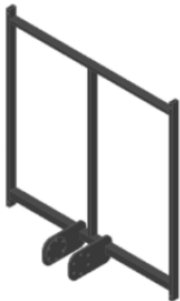
Estructura soporte de los espejos del heliostato.
