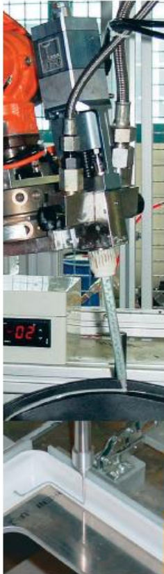
Aplicación con robot de un sistema de adhesivos aplicando Sikadur® que permite los ciclos cortos de producción equivalentes en la fabricación de moldes.
