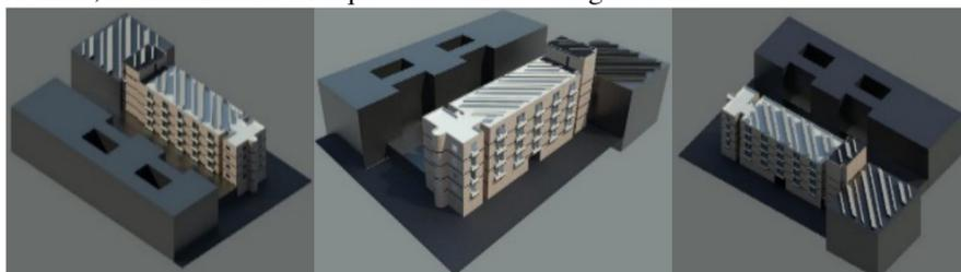
Fig 11 Imagen de la implementación adaptada sobre cubierta de tecnologías termicas y fotovoltaicas Alternativa 3. Elaboración propia
