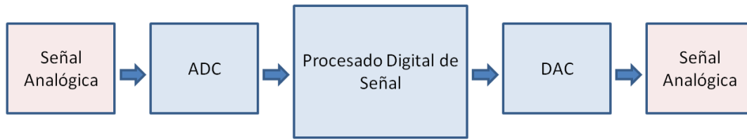
Figura 3.4. Diagrama de bloques simple de un DSP.
