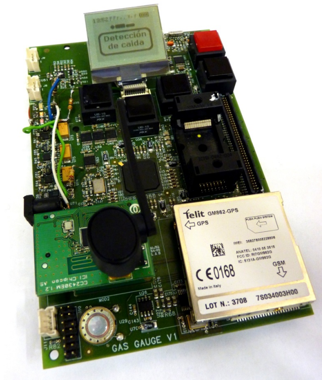
Figura 4.40. Prototipo preindustrial de la PIPM. En la parte inferior derecha se observa el módulo GSM (color blanco).
