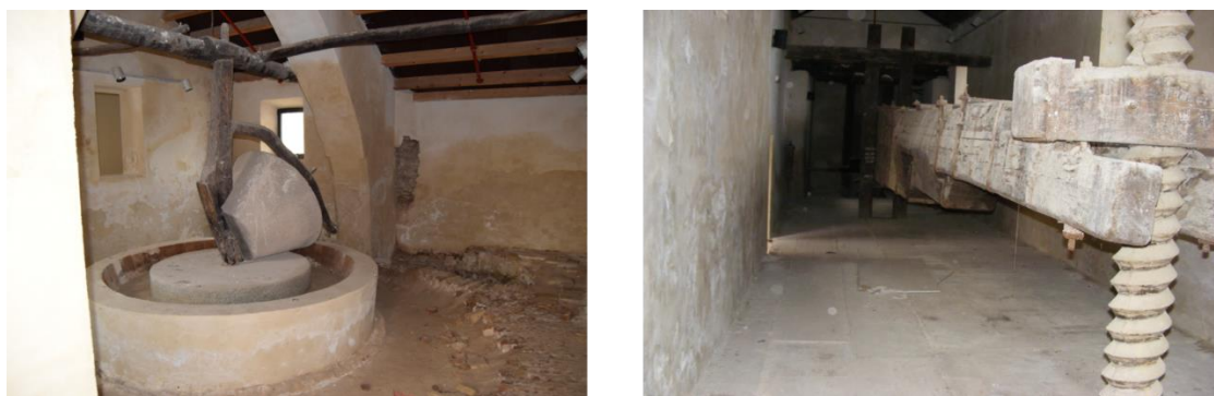
Figura 33. Molino troncocónico (izquierda) y Prensa de viga y quintal (derecha).
