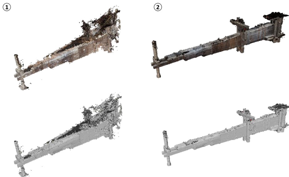
Figura 62. Nube de puntos densa de la Viga: (1) obtenida con la cámara Fujifilm Finepix y (2) obtenida con la cámara Nikon D3300.
