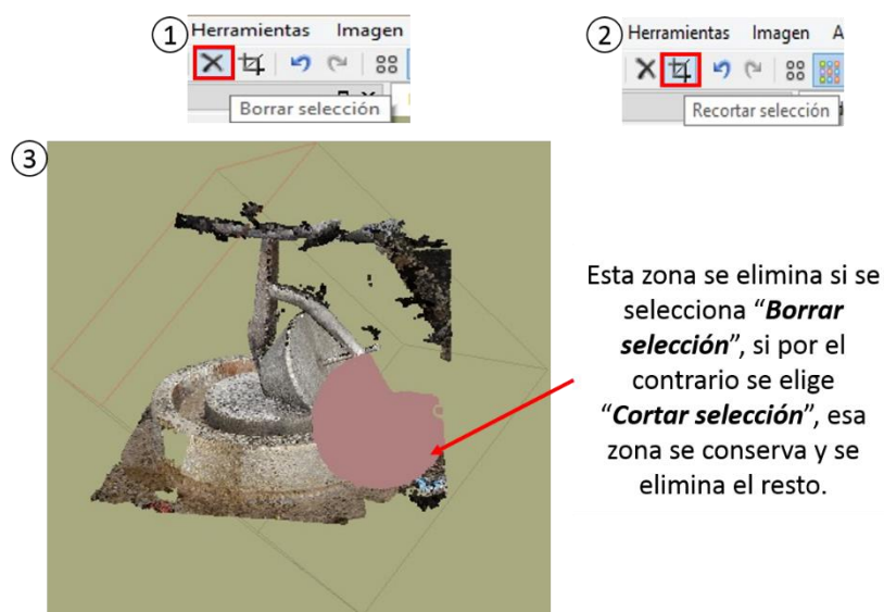
Figura 46. Borrado y cortado de la nube de puntos: (1) marcado de la opción “Borrar selección”, (2) marcado de la opción “Recortar selección” y (3) modelo editado.
