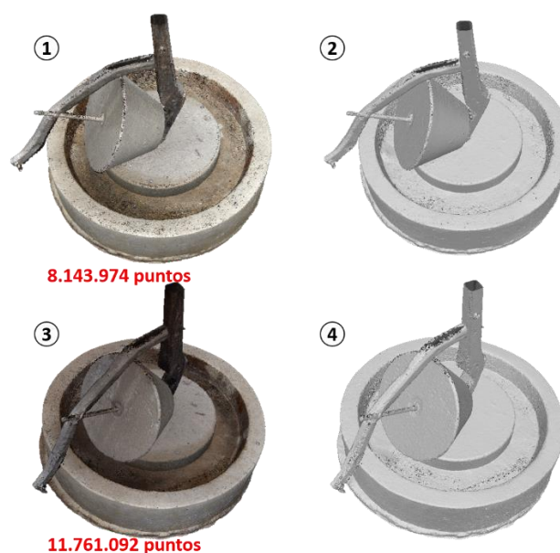
Figura 54. Nubes de puntos densa (izquierda) y clases de nubes de puntos (derecha): (1) y (2) corresponden a la cámara Fujifilm Finepix y (3) y (4) corresponden a la cámara Nikon D3300.
