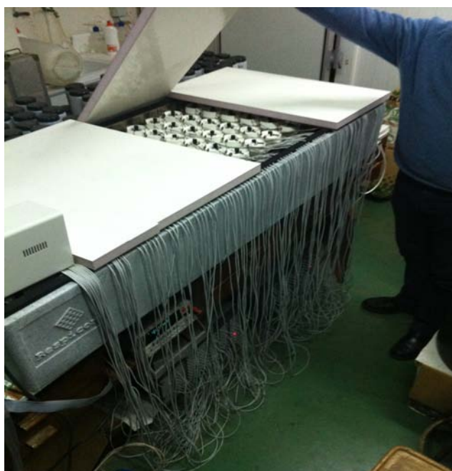
Figura III.5. Detalle del aparato Respicond IV (Nordgren Innovations, Sweden), disponible en el IRNAS-CSIC.
