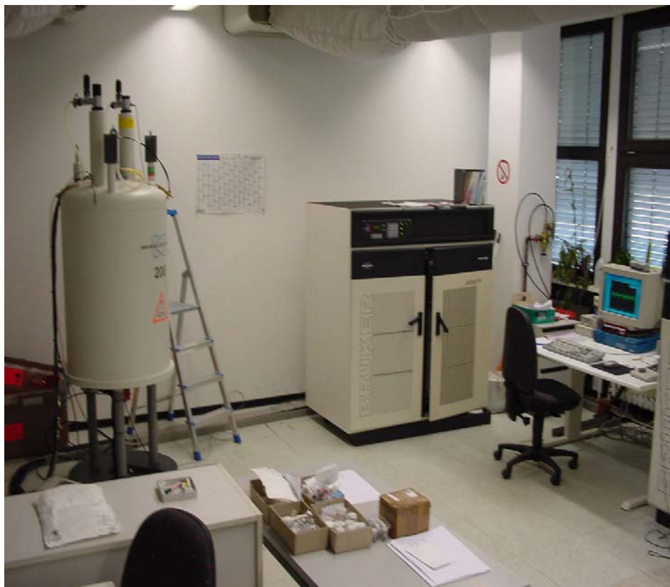
Figura III.8. Dispositivo utilizado de ^{13}\text{C} NMR (Bruker DSX 200). Universidad Técnica de Munich.
