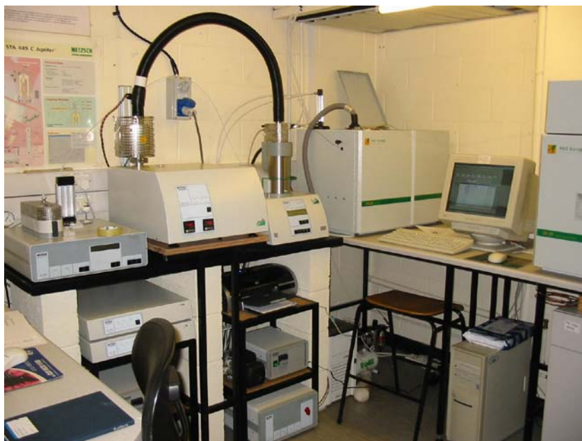
Figura III.6. Dispositivo de TG-DSC-QMS-IRMS. Universidad de Newcastle.
