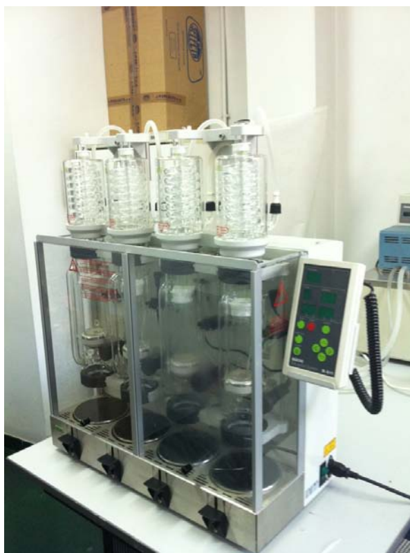
Figura III.9. Extracción de lípidos: dispositivo Soxhlet, disponible en el IRNAS-CSIC.
