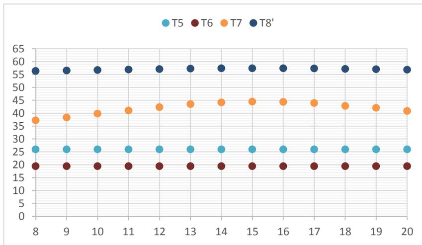
Figura 61: Temperaturas del ramal de regeneración
