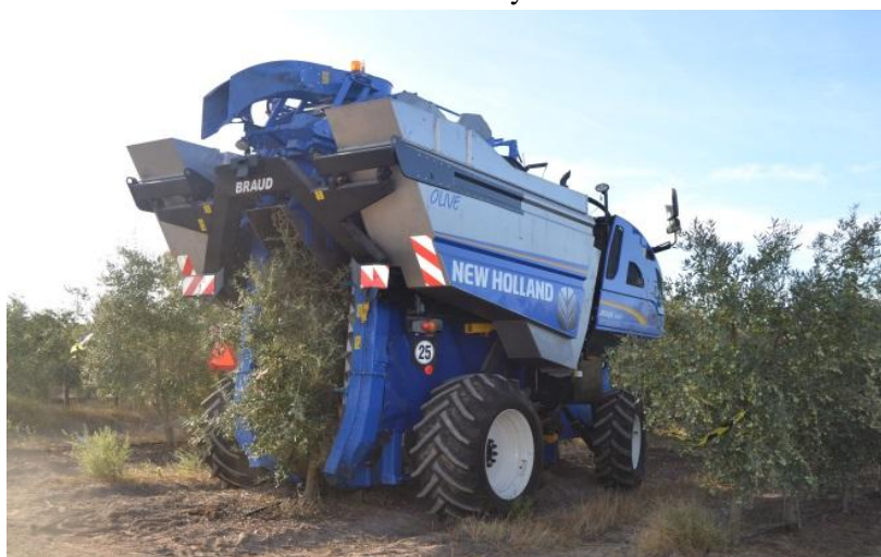
Figura 7.- Cosechadora cabalgante (V x 7090 Olive, Newholland) empleada en la recolección de los frutos de las variedades Manzanilla de Sevilla y Manzanilla Cacerreña.
