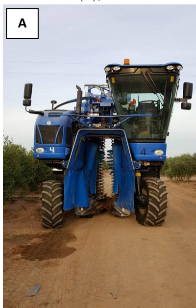
Figura 6.- Diferentes sistemas de recolección mecanizada: cosechadora cabalgante (Vx 7090 Olive, Newholland) (A), vibrador de tronco (B), vibrador manual motorizado (C).
