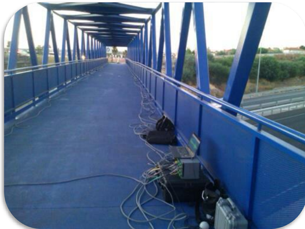
Figura 36. Montaje y realización del ensayo de vibración ambiental.
