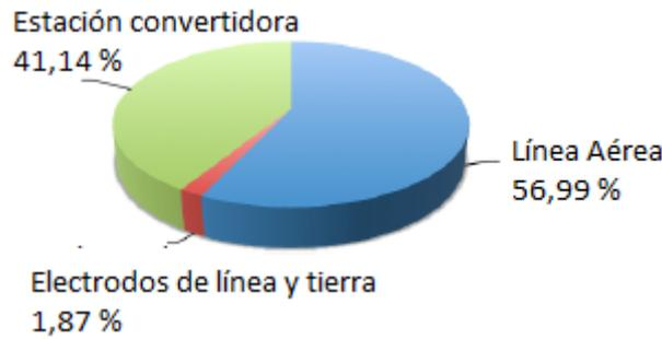
Figura 28: Línea aérea de 600 km. LCC HVDC  $\pm 500$  kV. 3.000 MW [3]
