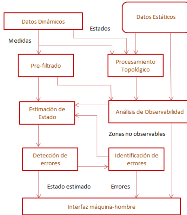
Ilustración 1. Esquema de funcionamiento del estimador de estado
