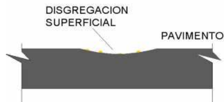
Ilustración 50. Detalle de la erosión. Fuente: (Porto Quintián, 2005)
