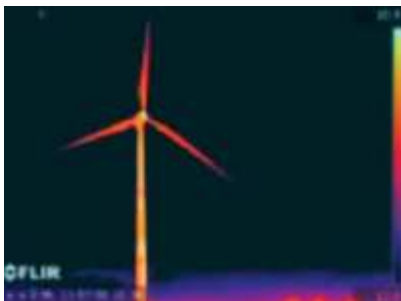
Ilustración 17. Imagen termográfica en la inspección de aerogeneradores. Fuente: (Jimeno, 2011)
