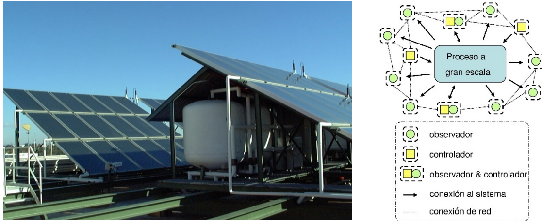
Figura 3. Arquitectura general de un campo solar del proyecto CODISOL
