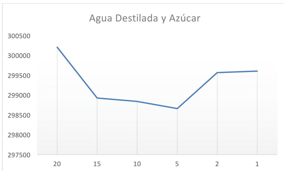
Figura 4-10. Frecuencia medida en agua destilada frente a disolución con azúcar
